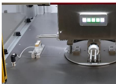
Durchgangsprüfstation sowie Be-/Entladestation für bis zu 2 Spulen
