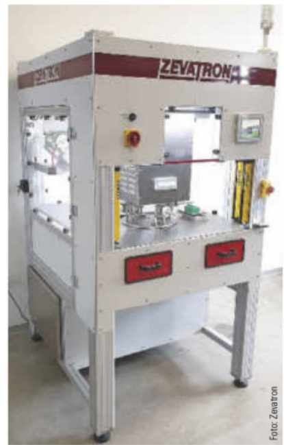
Löt-Rundtaktisch mit 4 Positionen und kodierten Fächern für NIO-Teile.
