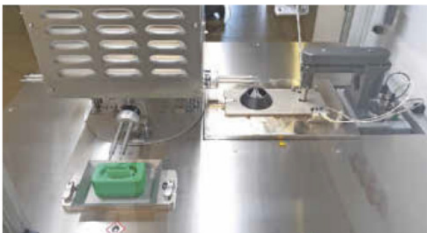
Fluxer und Verzinnposition, leicht zugänglich und austauschbar zu Reinigungs- und Wartungszwecken.
