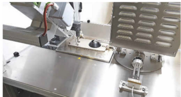
Lotpumpsystem mit kundenspezifischer Düse, automatischer Lotnachfuhr und Widerstandsprüfung.
